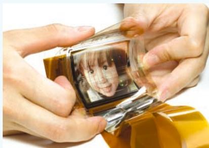
プラスチック基板上に有機薄膜トランジスタを用いたフルカラー有機ELディスプレイ
