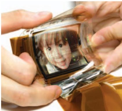
プラスチック基板上に有機薄膜トランジスタを用いたフルカラー有機ELディスプレイ
