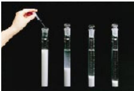
プラスチック廃材を利用した水溶性ポリマーによる凝集効果
