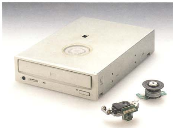
CD-ROMドライブおよびCD-ROMドライブ用電子部品(右後方:スピンドルモーター、右手前:光学ピックアップ)
