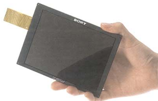
これは、当社が独自の低温ポリシリコンTFT形成技術を用いて試作に成功した5.6インチ・フルカラー液晶ディスプレイです。
