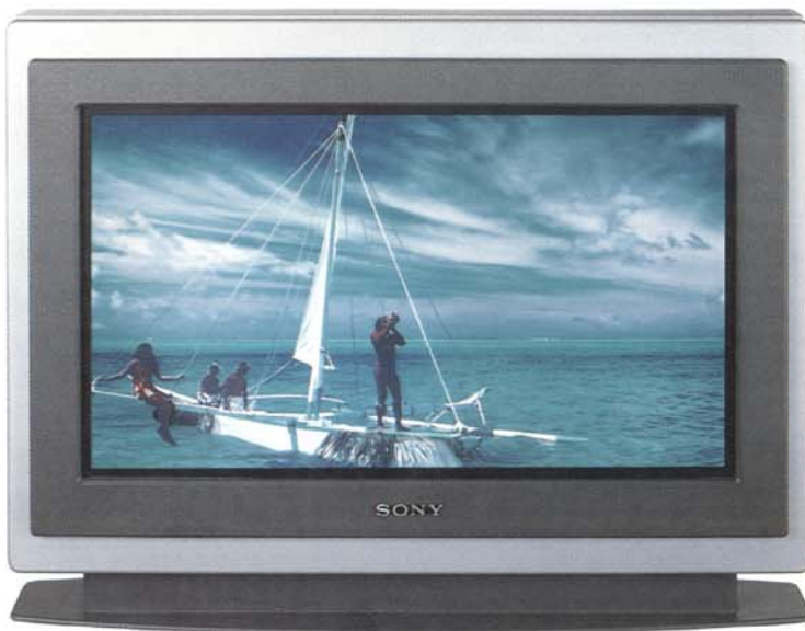
これは、フラットパネルディスプレイ“PLASMATRON(プラズマトロン)”の試作機です。(25インチ・ワイド画面)
