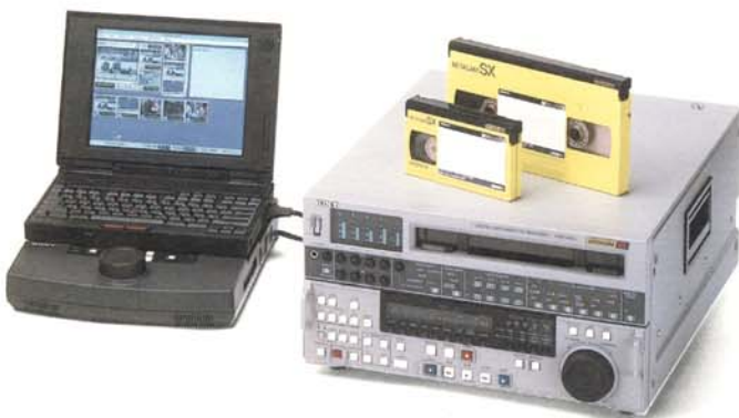
このポータブル編集システム(左)は、テープドライブとハードディスクドライブの双方を内蔵する“ベータカムSX”デジタルハイブリッド(混成型)レコーダーと組み合わせ、取材現場での効率的なノンリニア編集を可能にしました。
