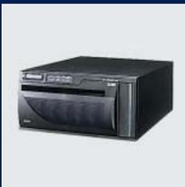
8ミリ幅カセットテープを用いたテープドライブシステム“AIT-2”規格に準拠したテープライブラリは省スペース性に優れ、ネットワークのブロードバンド化とともに増大するコンピューターのデータを、コンパクトなカセットテープに保存することができます。
