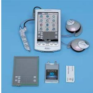
情報携帯端末“クリエ”の新機種には、薄型のリチウムイオン・ポリマー電池や高画質な映像を表示する低温ポリシリコンTFT液晶ディスプレイなど、ソニーが開発した高付加価値デバイスが採用されています。また、著作権保護に配慮したIC記録メディア“マジックゲートメモリースティック”を直接挿入することができるスロットを搭載しており、音楽を手軽に楽しむことができます。
