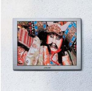
当年度において、ソニーは低温ポリシリコン TFTを用いたアクティブマトリクス型有機 ELディスプレイの大幅な画面化、高輝度・高精細化を実現する技術“TAC(タック)”を開発し、世界最大サイズ(2001年2月現在)となる13型のフルカラー有機ELディスプレイの試作機を発表しました。
