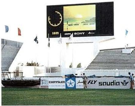
当社は、1992年夏、カタールのカリファ・スタジアムに既設の白黒スクリーンに替わる大型映像装置“ジャンボトロン”を納入しました。中近東に初めて設置された“ジャンボトロン”は、カタールのみならず近隣諸国のメディアでも好意的に紹介されました。中近東の強烈な太陽光線のもとでも見える鮮明な画質と摂氏50度を超える環境でも使用に耐えるように施された特別な冷却装置により、技術的にも高い評価を受けました。
