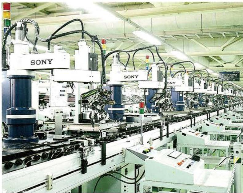
この産業用ロボットのラインアップは、精密機械組立工程に用いられ、当社だけでなくポラロイド社をはじめ世界中のメーカーにも採用されています。
