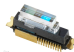
Blu-ray用光集積デバイス 原理試作品(14mm X 7.4mm X 3mm) 日亜化学株式会社との共同開発
