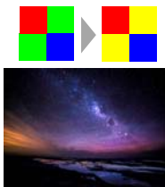
補色系カラーフィルタの適用 高感度かつ高色再現の実現
