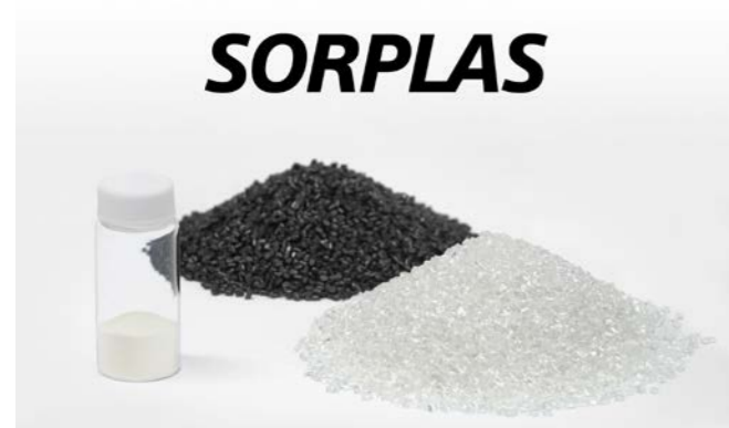
SORPLASの樹脂ペレット (黒色) と回収ペレット (透明: 右) とソニー独自の硫黄系難燃剤 (左)
