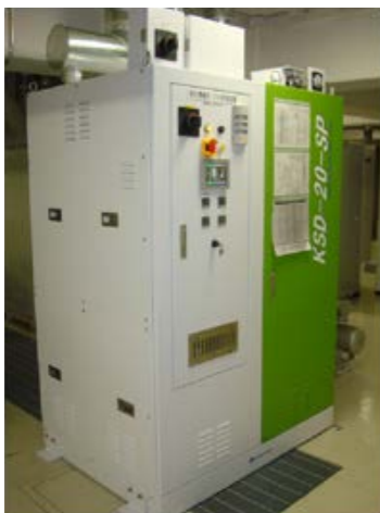
SCKが装置メーカーと共同開発した小型固定濃縮式VOC処理装置
