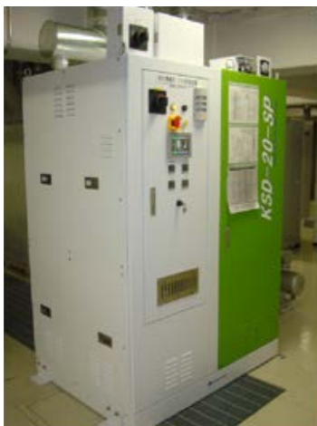
SCKが装置メーカーと共同開発した小型固定濃縮式VOC処理装置
