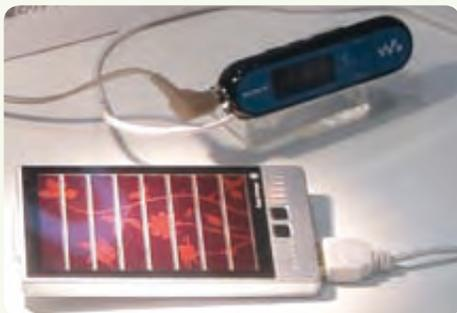
色素増感太陽電池/リチウムイオン電池ハイブリッドチャージャー試作機による「ウォークマン」再生デモ(2009年12月)
