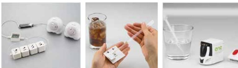
ぶどう糖水溶液で発電するバイオ電池試作機でウォークマンを再生（2009年2月）
