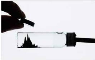
磁力に反応する磁性流体
